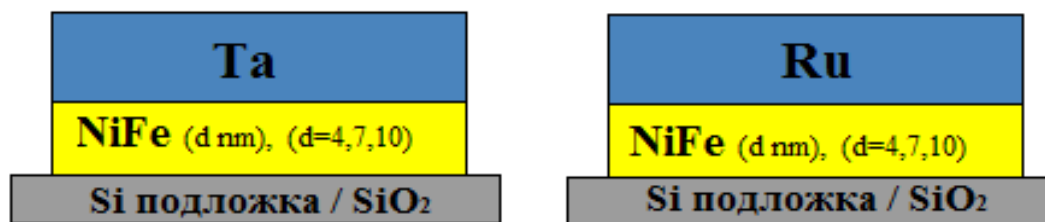
3 сурет – \text{SiO}_2/\text{NiFe}(d)/\text{Ta} және \text{SiO}_2/\text{NiFe}(d)/\text{Ru} жұқа магнитті қабықшаның схемасы
