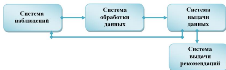
Рисунок 2 – Этапы технического мониторинга строительных объектов
